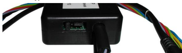
Положение перемычек для выбора автомобиля.
